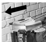
¡Desplazar la máquina siempre en la dirección especificada a través del material que va a ser mecanizado! Véase flecha (11) sobre la cubierta de protección. *De otro modo puede atascarse el disco, saltar de la pieza de trabajo o provocar un contragolpe.*
