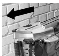
Toujours pousser la machine à travers le matériau dans le sens indiqué ! Voir flèche (11) sur le capot de protection. *La meule peut se coincer, se rapprocher ou provoquer un rebond si l'outil est redémarré lorsqu'elle se trouve dans l'ouvrage.*
