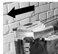
¡Desplazar la máquina siempre en la dirección especificada a través del material a ser mecanizado! Véase flecha (11) sobre la cubierta de protección. *De otro modo puede atascarse el disco, saltar de la pieza de trabajo o provocar un contragolpe.*
