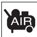
No utilice nunca gases reactivos, como oxígeno, gases combustibles, etc. como fuente de propulsión de esta grapadora. La utilización de estos gases, o de otros gases embotellados, es peligrosa, ya que la grapadora podría explotar.
