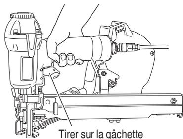
**MÉCANISME DE DÉCLENCHEMENT PAR CONTACT**
