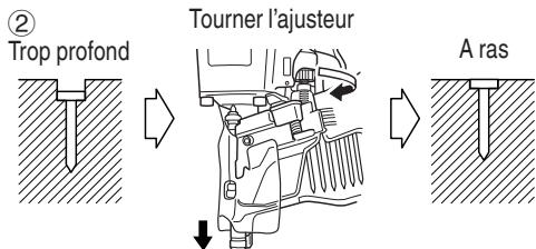
Si les clous ne s'enfoncent pas assez profondément, tourner l'ajusteur sur le côté profond.
