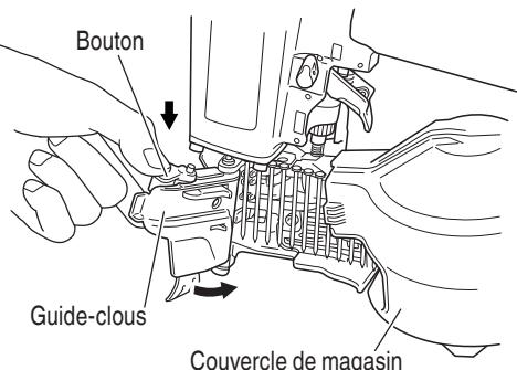
**REMARQUE:** Veiller à ne pas déformer les fils d'acier de liaison ni à libérer les clous avec la surface de guidage.
