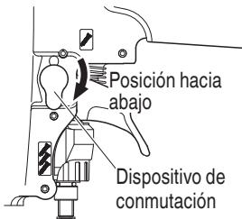
Con el clavador fuera de la pieza de trabajo, usted podrá cargar clavos en el mismo.
