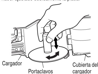
**NOTA:** Antes de cargar los clavos en el cargador, ajuste la placa. Si se cerrara la cubierta a la fuerza, sin ajustar correctamente la placa, sea podrá dañar el portaclavos.
