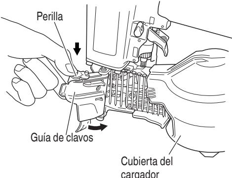
**NOTA:** Tenga cuidado de no deformar los alambres intercalados ni de desenganchar los clavos de la superficie de guía.
