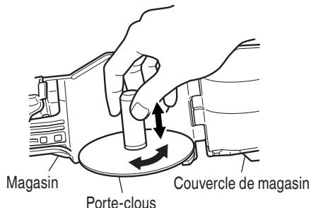
**REMARQUE:** Avant d'introduire des clous dans le magasin, régler la platine. Si le couvercle du magasin est fermé en forçant et sans que la platine ne soit réglée correctement, le porte-clous peut être endommagé.
